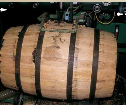
Le trou de bonde est foré au centre d'une des douelles.
