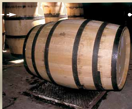
Mise sous pression du fût pour tester son étanchéité.
