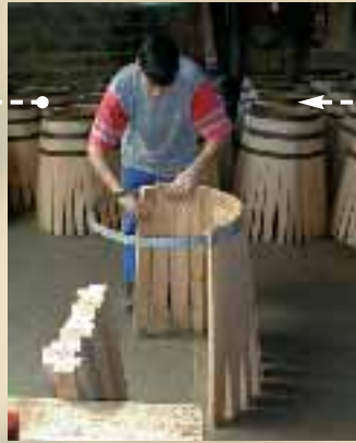
Les douelles sont placées dans le moule.
