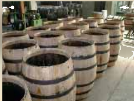
La chauffe d'agrément transforme certains composés du bois.
