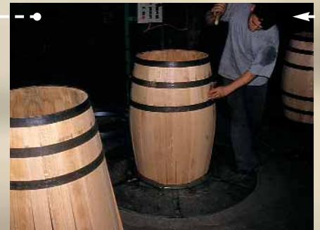
Opération de cintrage et mise en place, au marteau, des cercles provisoires.
