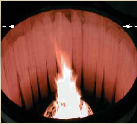
La chauffe technique est destinée à faciliter le cintrage.
