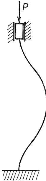
FIGURE 15.11 – Flambage d'une poutre bi-encastée.
