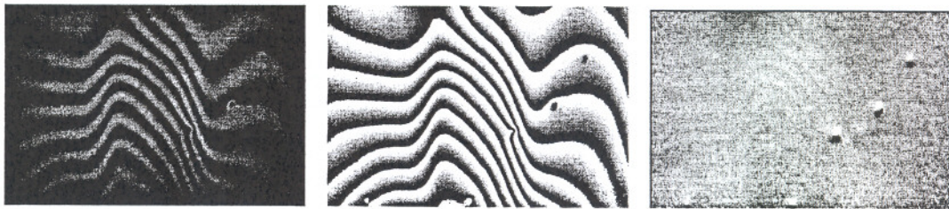
Figure 2. (a) interférogramme obtenu après chauffage d'un échantillon en CFRP contenant des défauts divers. (b) image de phase correspondante. (c) carte des défauts obtenue après traitement de (b).
