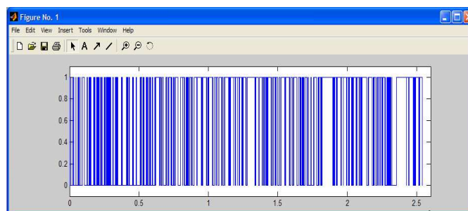
Figure 37 : Signal binaire d'une « photographie reconstituée » (en abscisse la longueur en 10^5 x pixels).
