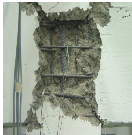
Figure 10.24. Sollicitation de cisaillement du nœud poutre poteau. Figure 10.25. Etat Limite Ultime d'un nœud correctement armé dans une situation « poutre forte- poteau faible ».
