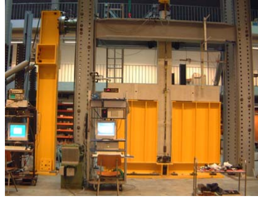
Banc d'essai à l'Université de Liège. Des plaques d'acier raidies (en jaune) simulent des remplissages raidés en maçonnerie.
