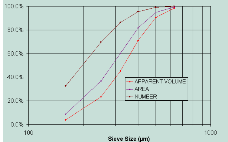
Fig.IV-9. Granulométrie par analyse d'images obtenues sur un sable selon que la pondération se fait en nombre, en aire projetée ou en volume apparent.
