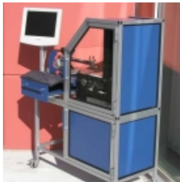
Fig. IV_4. Le granulo-morphomètre Alpaga commercialisé par la société Occhio exploite la flexibilité d'une courroie de lames de verre pour optimiser la dispersion, la focalisation et la disposition des particules dans le champ de prise d'images.
