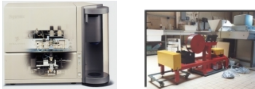
Fig. IV_2. Le système Sysmex développé par Malvern couvre une gamme granulométrique de 0.7 à 40 \mu\text{m} ou de 4 à 160 \mu\text{m} . Les particules y sont mises en suspension dans un fluide afin de mieux contrôler leur position dans le champ de vision de la caméra (doc. Malvern).
