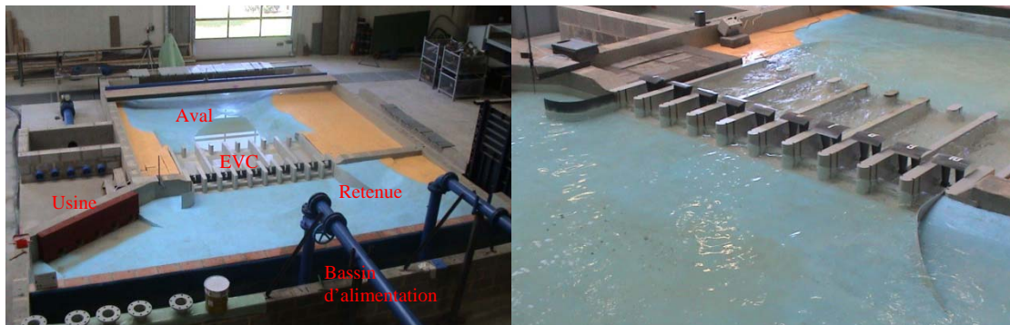
Figure 2 : Vues du modèle réduit de l'EVC (Générale – gauche, et détail des passes et du bassin de dissipation – droite)
