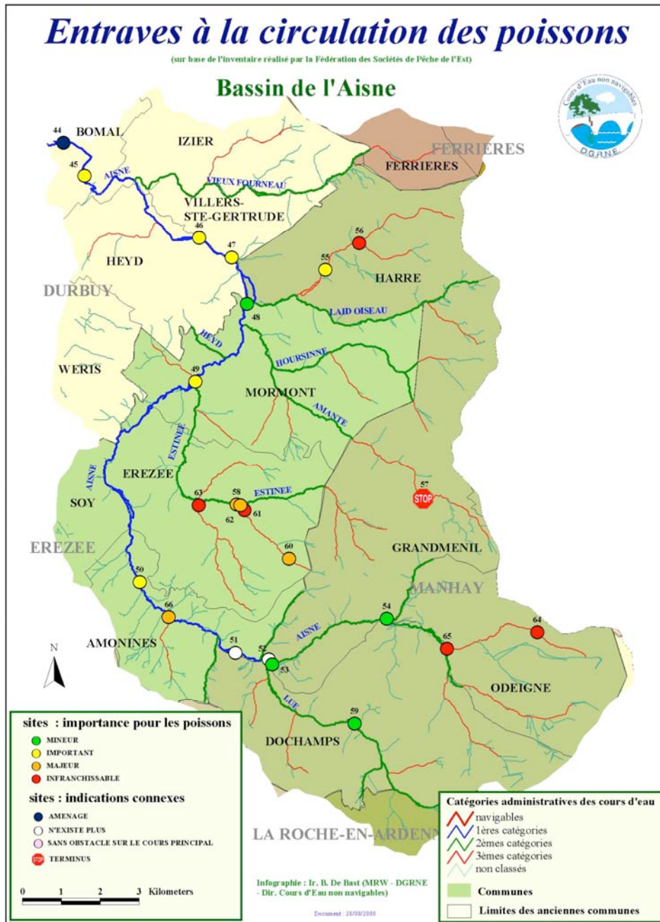
Figure 9 : Entraves à la libre circulation des poissons l'Aisne : obstacles 44 à 49. Inventaire et classification des obstacles avant les suivis par radio-pistage (source B. Bast, MRW-DGRNE).
