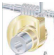
FIG. 5.14 – Réduction finale vis/secteur à butée franche
