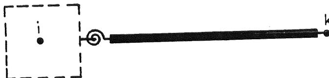
c - Élément "poutre(colonne) + ressort d'assemblage + panneau d'âme"
