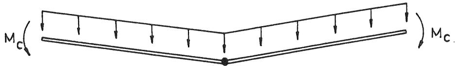
Figure 8.28. - Annulation de la rigidité flexionnelle de la poutre suite à l'apparition d'une rotule plastique à mi-travée.
