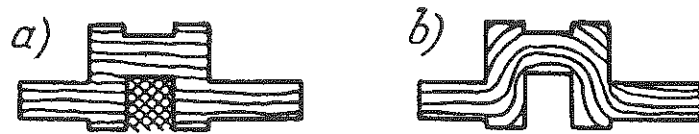
Répartition des fibres dans un vilebrequin a – usinage par coupe; b – forgeage (matriçage)
