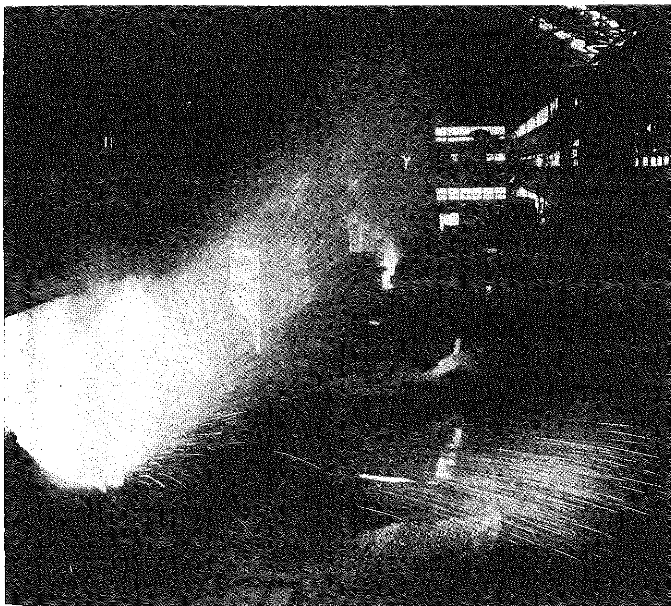
CONVERTISSEUR EN COURS DE SOUFLAGE. — Tout d'abord, le silicium contenu dans la fonte brûle au contact de l'air en produisant des gerbes d'étincelles. La flamme s'allonge ensuite et la masse est brassée par l'air, c'est la combustion du carbone. Le phosphore est alors éliminé au milieu des nuages de fumées rousses d'oxyde de fer.
