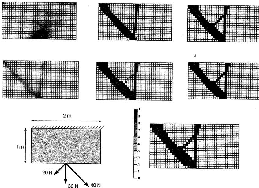
té sous l'action de trois chargements d'intensités et de directions différentes. Au cours des itérations, le "nuage" de matériau composite poreux se transforme progressivement en une distribution qui suggère une structure formée d'un treillis 2 barres.
