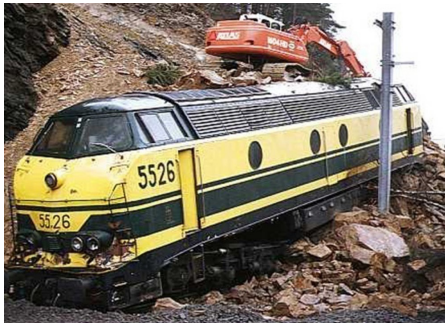
Déraillement d'une locomotrice suite à l'éboulement d'une paroi à Roanne-Coo (Commune de Stoumont).
