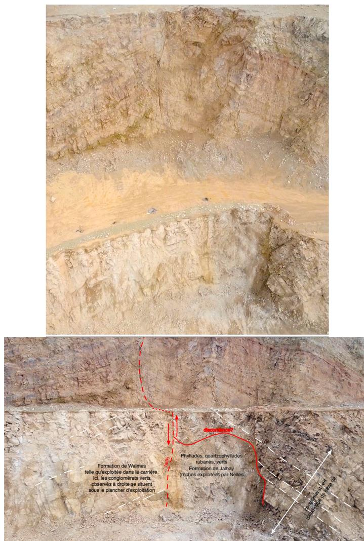
Figure 25. Vues aériennes (JMM, drone, 12/2016) de la carrière de Waimes montrant une des failles bordières (SE) du Graben de Malmedy et son action sur l'allure des couches: le compartiment de droite (nord-ouest est descendu, les bancs sont rebroussés (crochons) au contact de la faille subverticale.
