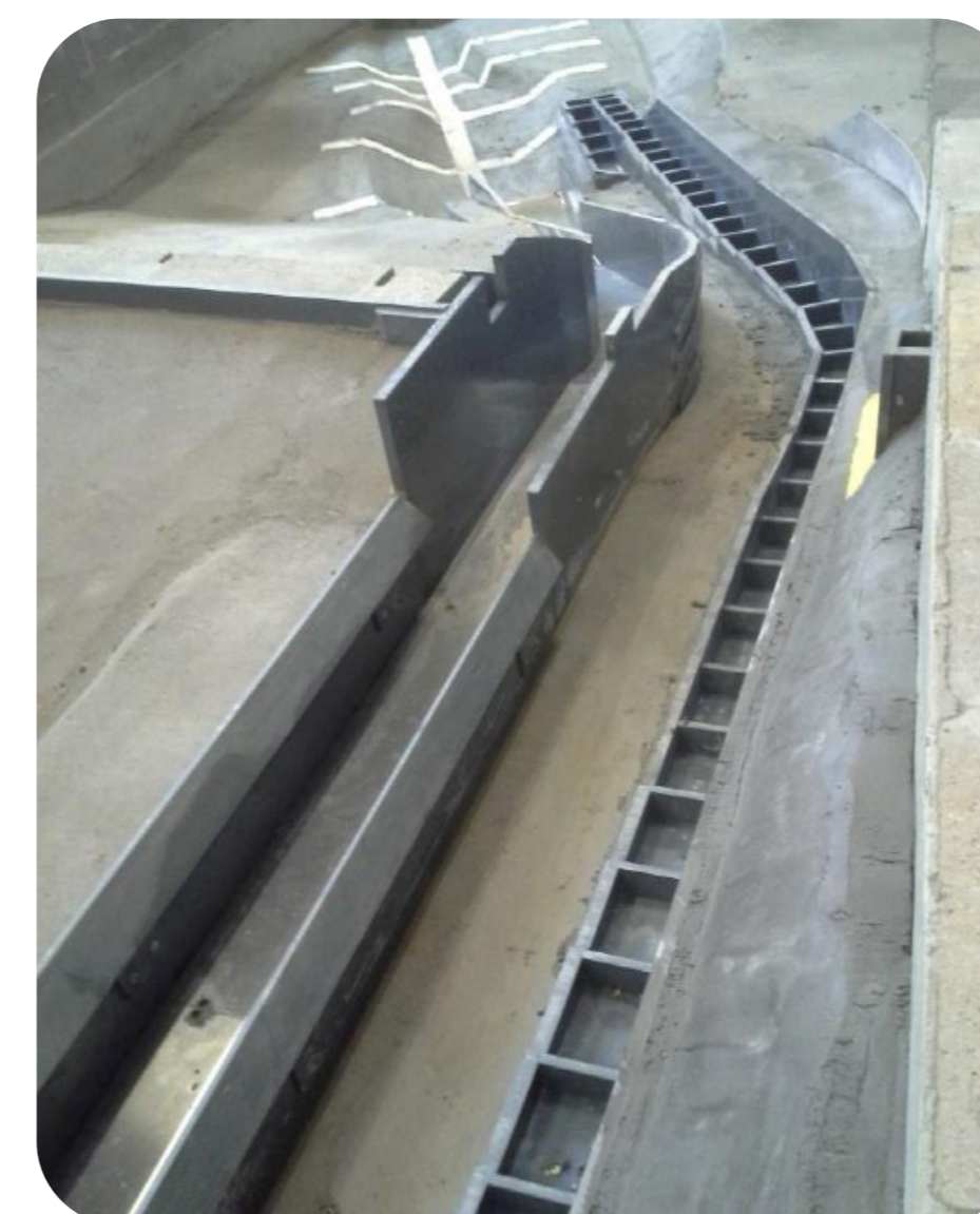
Géométrie 1 – Intégration de l'échelle à poissons
