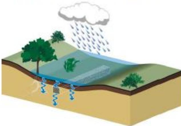
Figure 4 - Noue infiltrante avec enrochement linéaire en son point bas afin de limiter l'apparition de flaque. Ce massif n'est pas drainé par une évacuation vers un exutoire mais permet de stocker temporairement une partie des eaux de ruissellement. Toute l'eau stockée dans la noue et son enrochement sera ensuite infiltrée dans le sol. Source Architecture & Climat.
