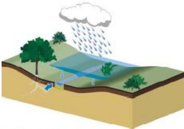
Figure 3 - Noue infiltrante à ouverture en son creux pour évacuer les petits épisodes pluvieux et le début et/ou la fin des épisodes plus rares afin d'éviter les flaques. Source Architecture & Climat.
