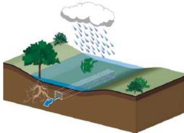
Figure 6 - Noue drainante sur un sol très peu perméable. Les eaux stockées dans la noue s'infiltrent dans le substrat superficiel et sont drainées dans un massif qui évacue les eaux à débit régulé vers un exutoire. Source Architecture & Climat.
