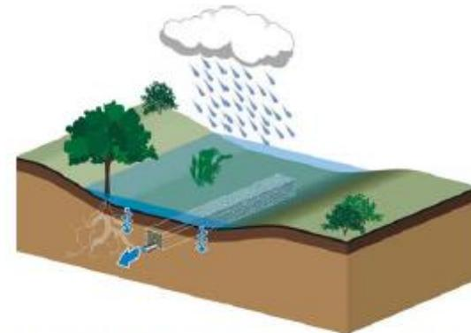
Figure 8 - Noue mixte, à la fois infiltrante et drainante, sur un sol moyennement perméable. Source Architecture & Climat.
