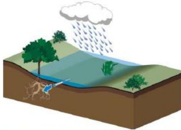
Figure 5 - Noue à évacuation superficielle. Le sol est très peu perméable. Les eaux stockées sont évacuées à débit régulé vers un exutoire via un orifice au pied de la noue. Cet orifice doit être très régulièrement entretenu pour éviter toute obstruction. Source Architecture & Climat.
