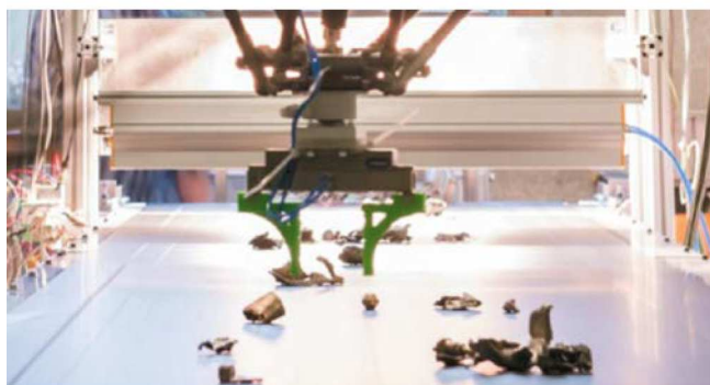
Figure 1. Prototype de tri intelligent des alliages métalliques développé par le département de Génie Minéral, Matériaux et Environnement (GeMME) de l'Université de Liège.
