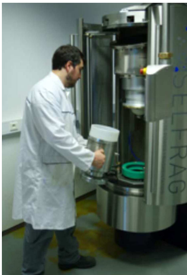
Figure 2. Equipement expérimental de fragmentation électrodynamique acquis par le département GeMME de l'Université de Liège pour favoriser la libération des métaux à des fins de recyclage.
