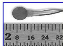
Figure 34 : Caractéristiques techniques du capteur de force : Modèle 105, Precision Measurement Company®, Ann Arbor, USA.
