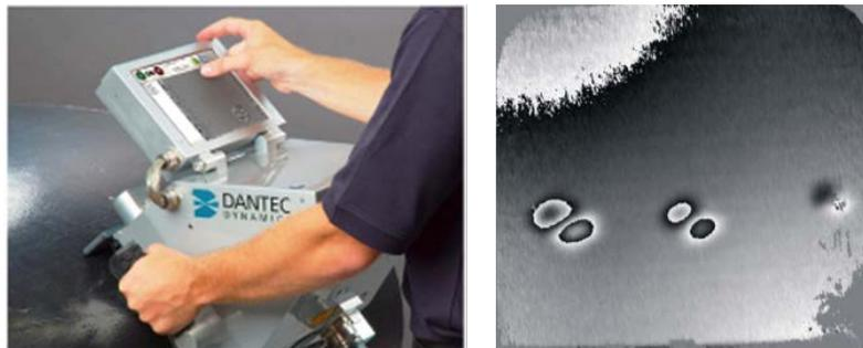
Figure 35. Système shearographique avec excitation thermique pour la détection de défauts (ici sur pale d'éolienne en composites)
