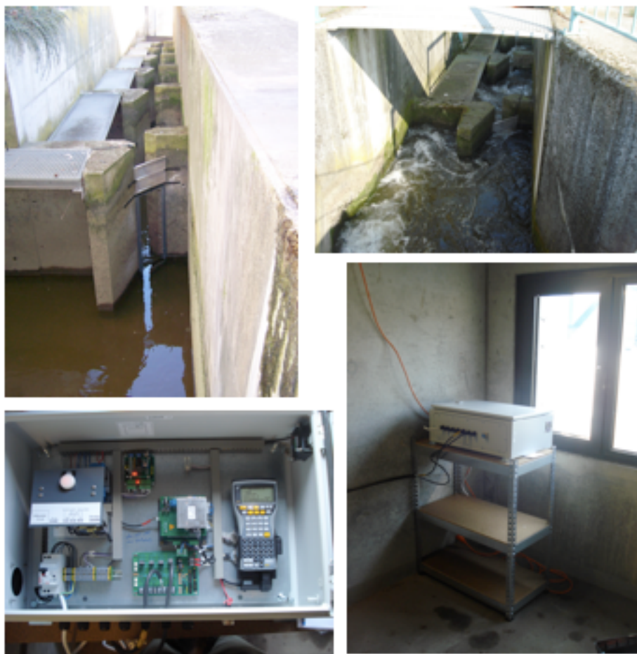
Figure 6. Détecteur RFID installé en 2011 dans la passe à bassins du barrage d'Ivoz-Ramet sur la Meuse (km 97,1). Au-dessus : antenne de détection placée sur la fente du bassin supérieur à sec (à gauche) et sous eau (à droite). En-dessous : boîtier électronique (à gauche) abrité dans un local du barrage + centrale hydroélectrique (à droite).
