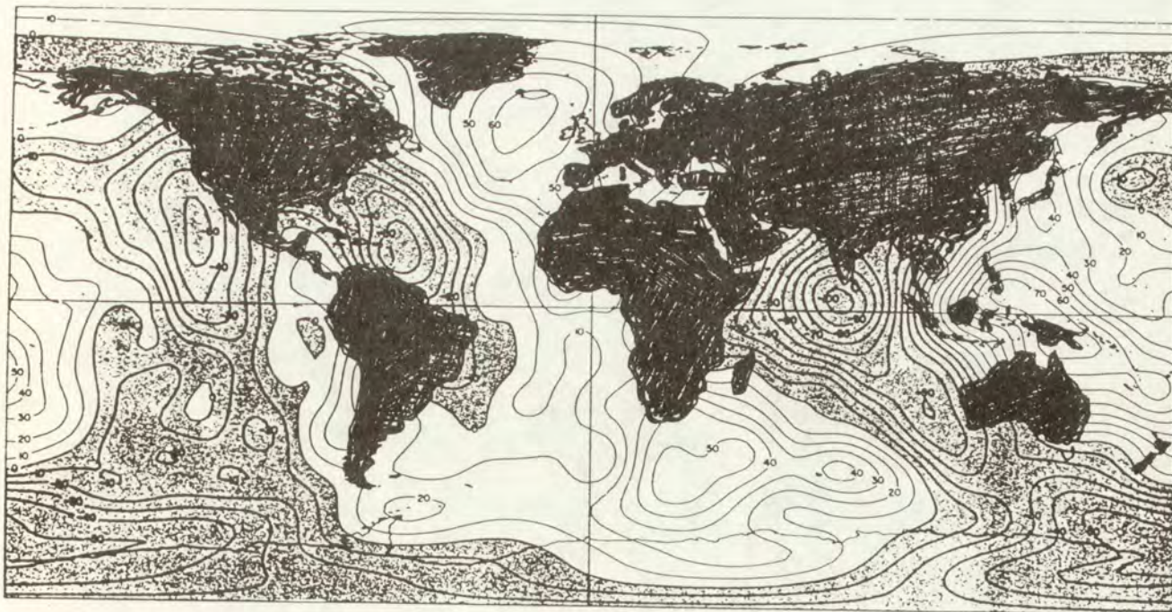
FIGURE 35. Carte du géoïde III selon les normes du Smithsonian Institute (Gaposchkin, 1973), indiquant, en mètres, les différences par rapport à l'ellipsoïde régulier le plus proche. Erreur absolue \pm 3 m. Equidistance 10 m. (Mörner, 1976)
