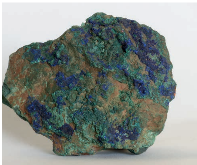
Fig. 4 : En haut: minerai de cuivre constitué de placages de malachite (vert) et d'azurite (bleu), sur une roche fine, argileuse : le minerai doit donc être broyé et la malachite séparée des phases stériles pour produire le métal; gisement de Mindouli, longueur 10 cm. En-dessous: Échantillon de malachite botryoidale; gisement de Boko-Songho, longueur 8cm (Th. De Putter 2015).
