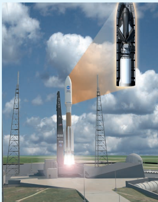
Vue d'un Dream Chaser avec les ailes repliées sous la coiffe d'une fusée Atlas V. © Sierra Nevada Corporation
