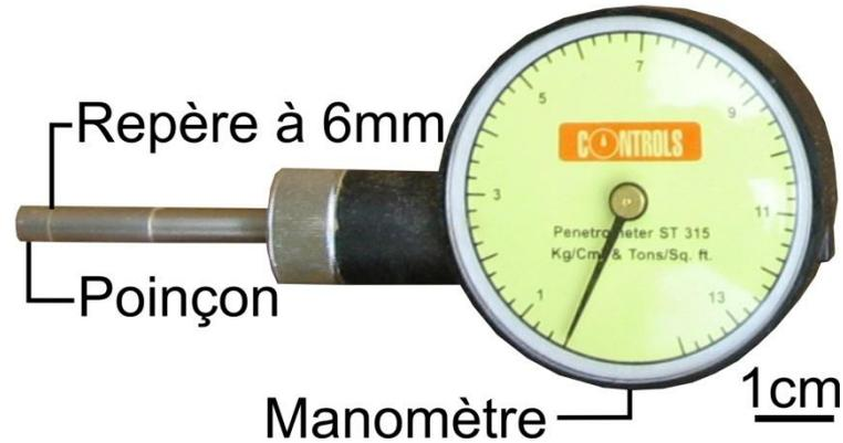
Mesure d'une **résistance à l'enfoncement**
