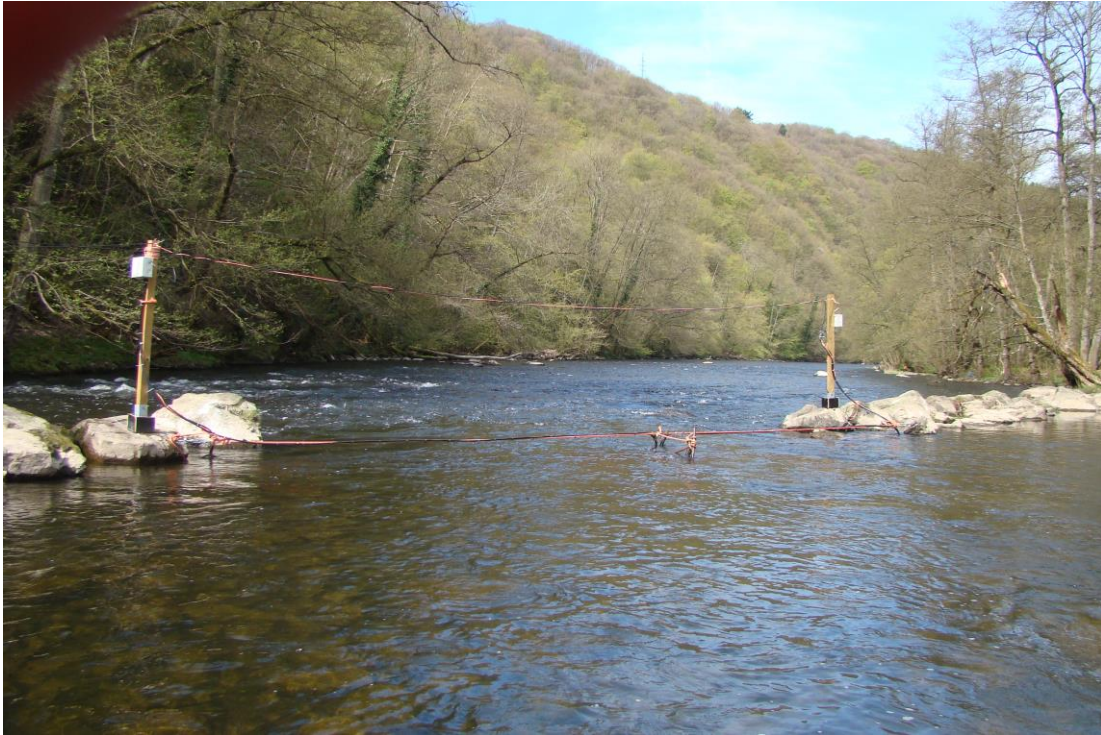
Figure 29 : Vue amont des deux antennes de détection RFID installées à la fin du débit réservé à Heid de Goreux
