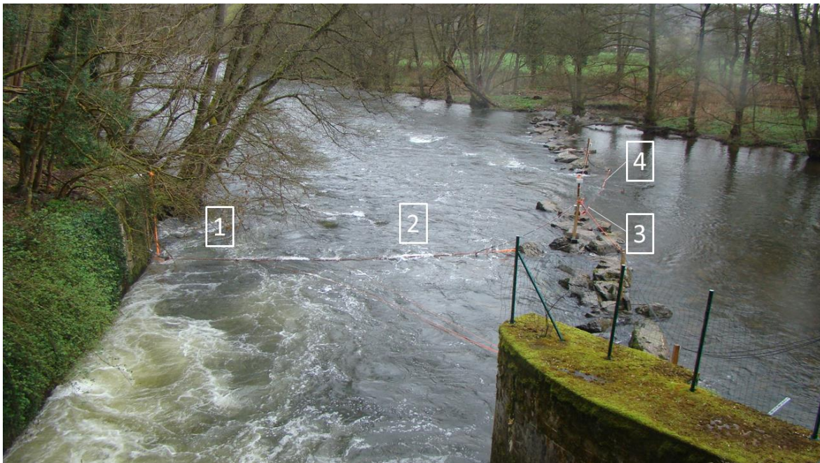
Figure 32 : Vue amont du dispositif de détection installé à Heid de Goreux avec les antennes 1 et 2 (canal de fuite : sortie des turbines) et les antennes 3 et 4 (fin du débit réservé)
