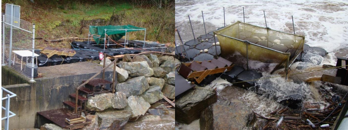
Figure 19 : Retrait du piège de dévalaison lors de pics de débit (>30m 3 /s) (à gauche) et incapacité de contrôler le piège (à droite)
