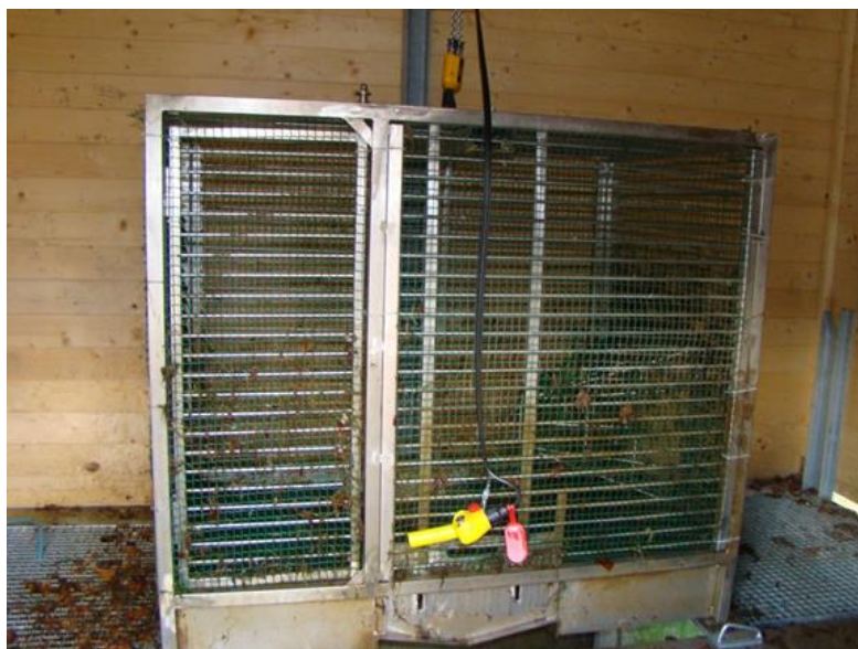
Figure 20 : Cage de capture placée au niveau du bassin le plus en amont de l'échelle à poissons du barrage de Lorcé
