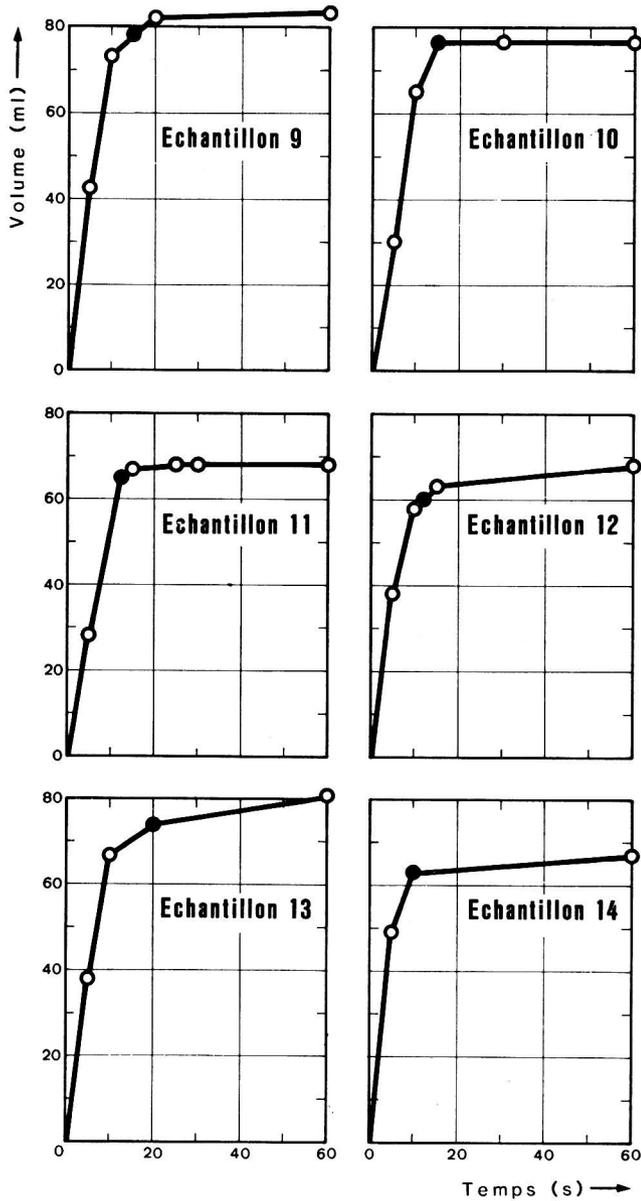
FIG. 3. — Courbes du dégagement gazeux des échantillons 9 à 14. Le point noir représente le volume de CO<sub>2</sub> dégagé à jet continu.
