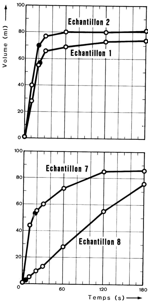
FIG. 2. — Courbes du dégagement gazeux des échantillons 1, 2, 7 et 8. Le point noir représente le volume de CO<sub>2</sub> dégagé à jet continu.
