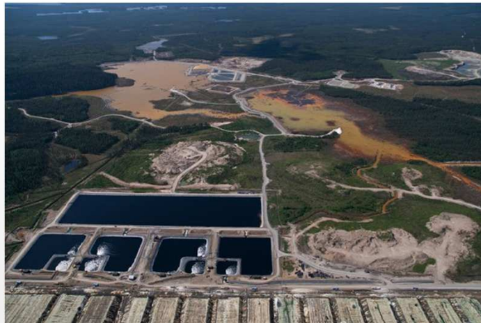
Bioheap leaching à Talvivaara (FIN) 1.3 Mt @ 0,23 % Ni ; 0,02% Co; 0,13 % Cu; 0,5 % Zn
