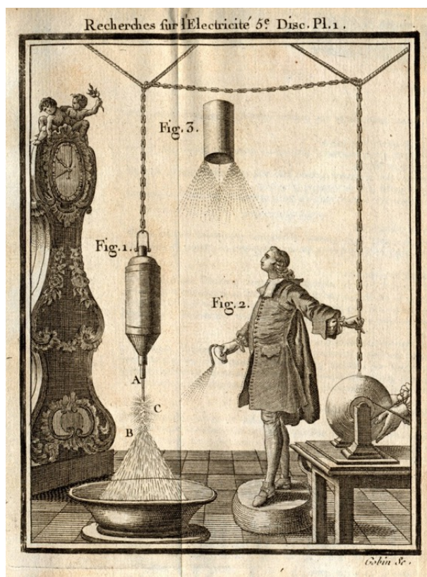
Figure 2.5: Schema extracted from Nollet's book "Recherches sur les causes particulières des phénomènes électriques et sur les effets nuisibles ou avantageux qu'on peut en attendre" [25]. Different setups ("Fig". 1, "Fig. 2" and "Fig. 3" ) emit electrically charged droplets. The part of the schema named Fig 1 B shows the conical repulsion between charged droplets.
