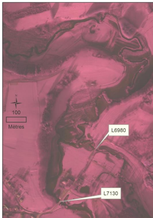
Figure 60 : orthophoto (proche infrarouge) de la Vierre le 19/12/2012 ( Q = 16.3 \text{ m}^3/\text{sec} ) et du ruisseau de Neufchâteau ( Q = 6.5 \text{ m}^3/\text{sec} ) à proximité de Martilly, tout deux en phase de crue.
