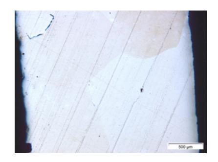
$\rightarrow$  MGS  $\sim 60 \ \mu m$  $\rightarrow 110 \text{ HV}$
