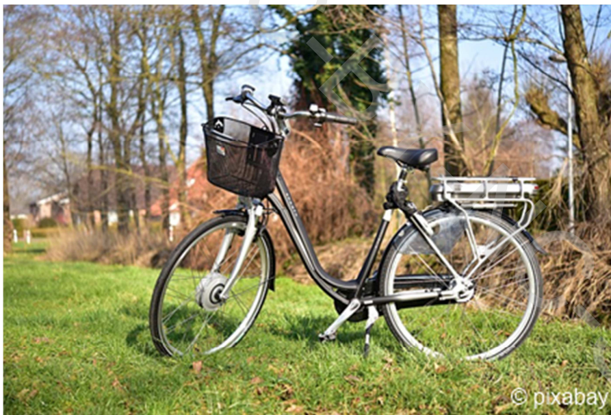
Image 1 - Vélo à assistance électrique avec un moteur sur la roue avant et la batterie sur le porte bagage.
