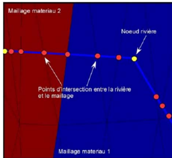
Figure 9 : Représentation d'un réseau de rivière dans un maillage illustratif. Les points jaunes représentent les nœuds auxquels les données caractérisant la rivière sont connues, les points rouges les points d'intersection entre les segments de rivière et les limites des mailles (Lorenzini, 2008a).
