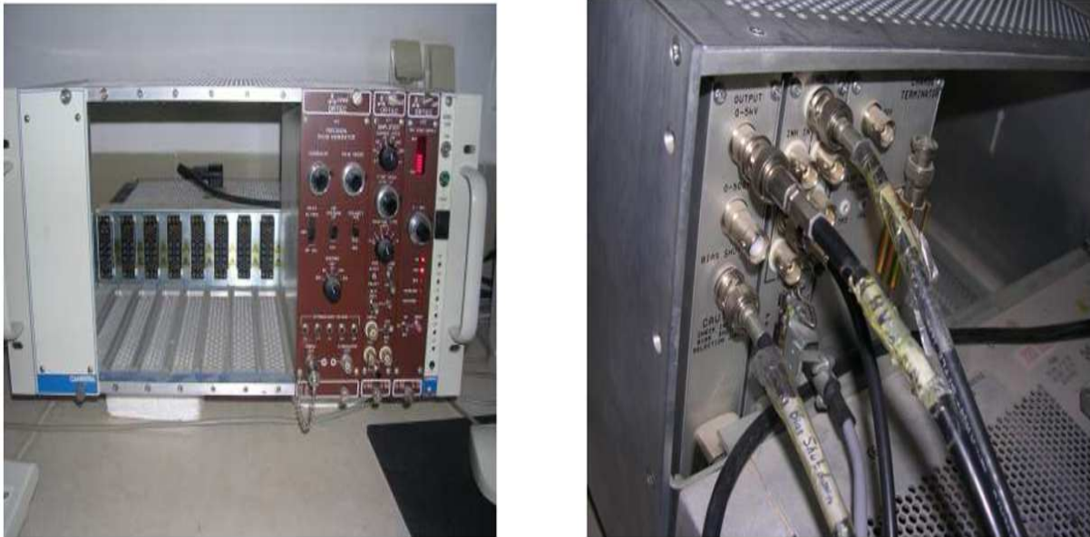
FIGURE 2.7 – a) NIM (haute tension+MCA) vue avant. b) vue arrière. module électronique d'un spectromètre gamma.
