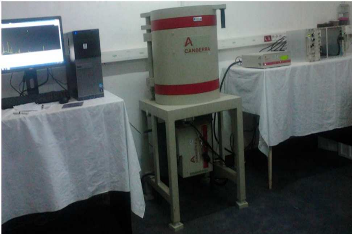
FIGURE 2.6 – Détecteur HPGe CANBERRA du laboratoire de Dosimétrie et Radioprotection de l'ANRP.
