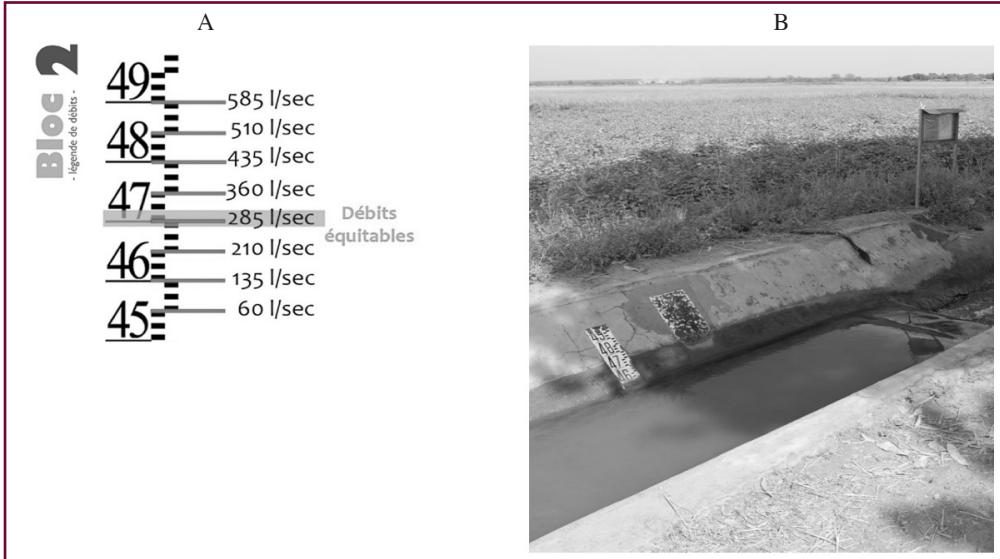
Figure 9.4. A. Fiche de légende de débits, avec le débit proposé en vert ; B. Échelle hydrométrique et tableau avec la fiche de légende de débits.
