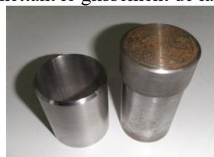
Massif de consolidation de la boue et son instrument de mise en forme
