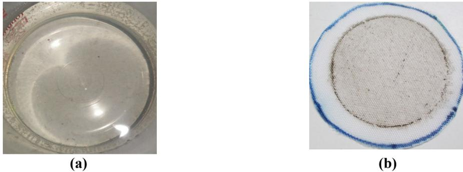
**Figure 56 : Aspect du filtrat (a) et qualité de la toile après décollage du gâteau (b) en référence à l'utilisation de la membrane filtrante F10**
