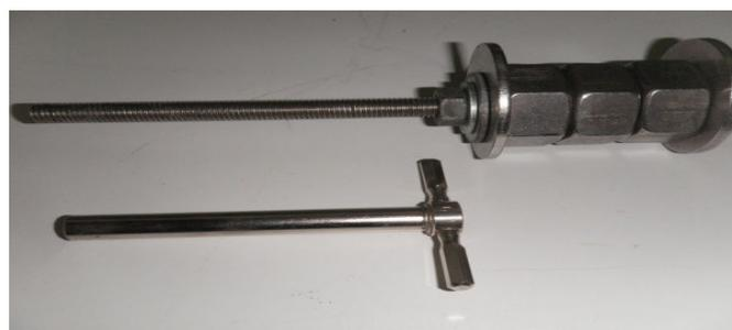
**Figure 39 : Outil de mise en forme des échantillons**
