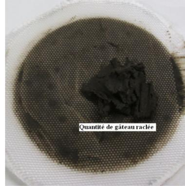
→ Le colmatage conduit à un blocage des pores du média filtrant entraînant une réduction de la perméabilité du gâteau.
