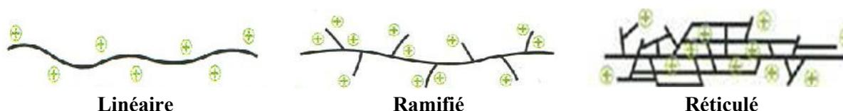
**Figure 32 : Différenciation architecturale des polymères (Document technique SNF)**
