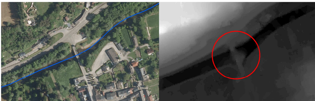
FIGURE 11 : "DIGUE" ARTIFICIELLE DANS LE MNT LIDAR - CAS DU VIROIN (OLLOY-SUR-VIROIN)
