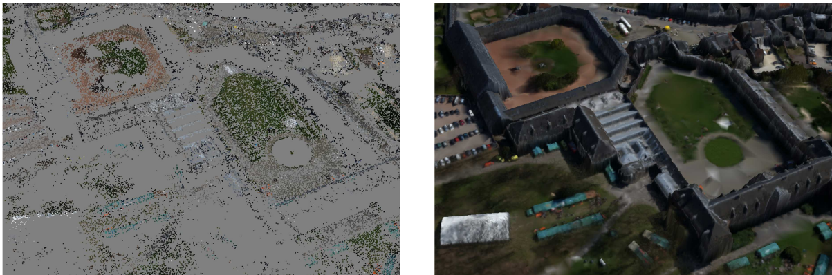
FIGURE 6 : NUAGE DE POINTS HOMOLOGUES (OBTENU EN FIN DE PHASE D'ORIENTATION/AÉROTRIANGULATION) ET MODÈLE NUMÉRIQUE DE SURFACE (DÉRIVÉ DU NUAGE DE POINTS DENSE)
