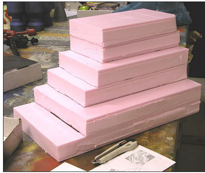
XPS – eXtruded PolySterene ↑ Polystyrène extrudé boîtes à CD
