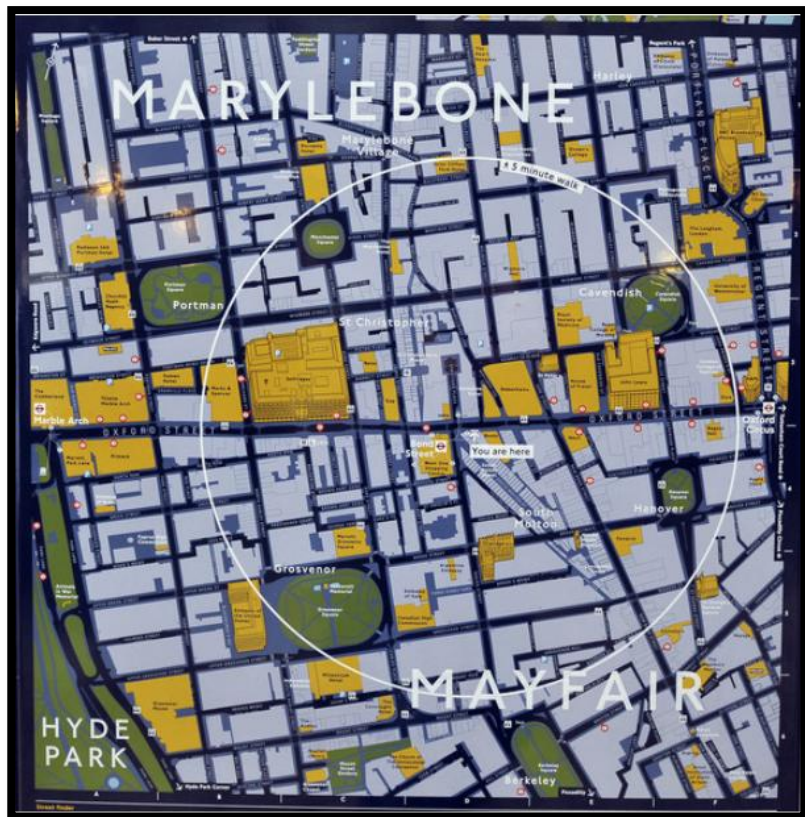
Figure 23 : Zoom sur le plan. On remarque le cercle isochrone tracé autour de la position où se trouve le panneau. Certains bâtiments sont mis en jaune et sont dessinés en trois dimensions. C'est une manière d'aider le piéton à s'orienter plus facilement dans la ville.
