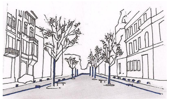
Figure 44bis : Vue de l'espace central piétonnier du boulevard Saucy qui se situe dans l'axe de la passerelle. L'encadrement par les arbres et la largeur de l'espace laissé aux marcheurs procurent une sensation de confort. Les voies de circulation à droite et à gauche sont très minces et sont également revêtues de pavés qui contribuent à réduire la vitesse de circulation des voitures.
