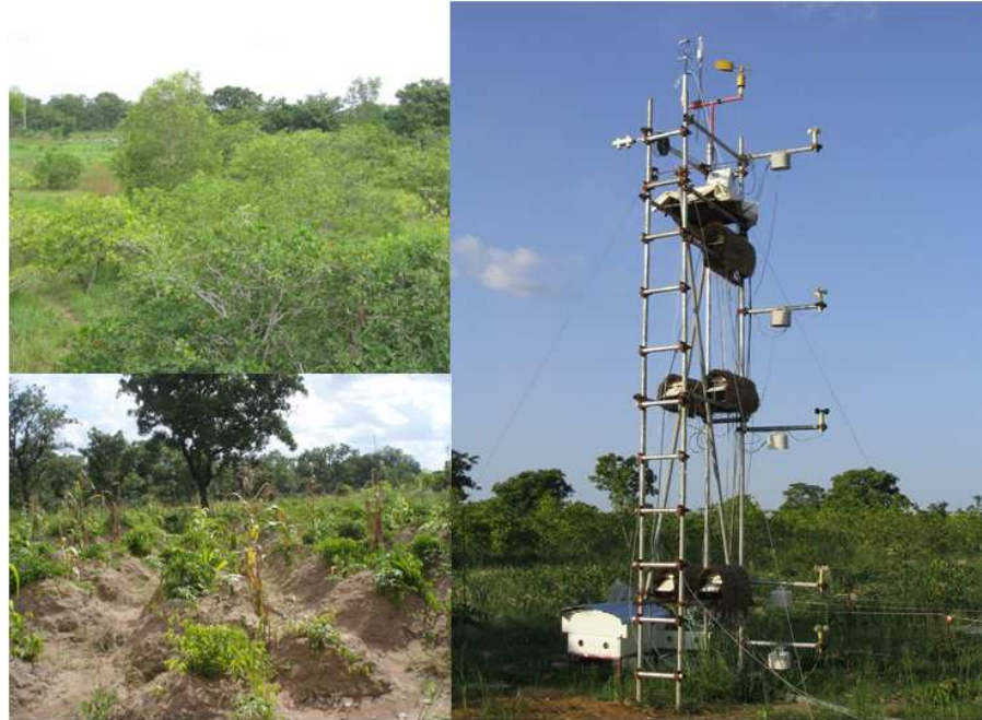
Figure 8. Le dispositif de mesure d'eddy-covariance dans la forêt claire cultivée de Nangatchori avec l'état de la végétation pendant la saison pluvieuse. Photo (SERCA, 2006 ; AGO, 2012)
