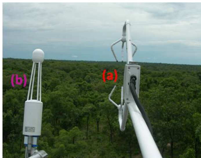
Figure 5. Système d'eddy-covariance au-dessus de la forêt au Bénin (site de Bellefougou): (a) anémomètre sonique tridimensionnel CSAT 3 et (b) analyseur de gaz infrarouge à circuit ouvert LICOR 7500.
