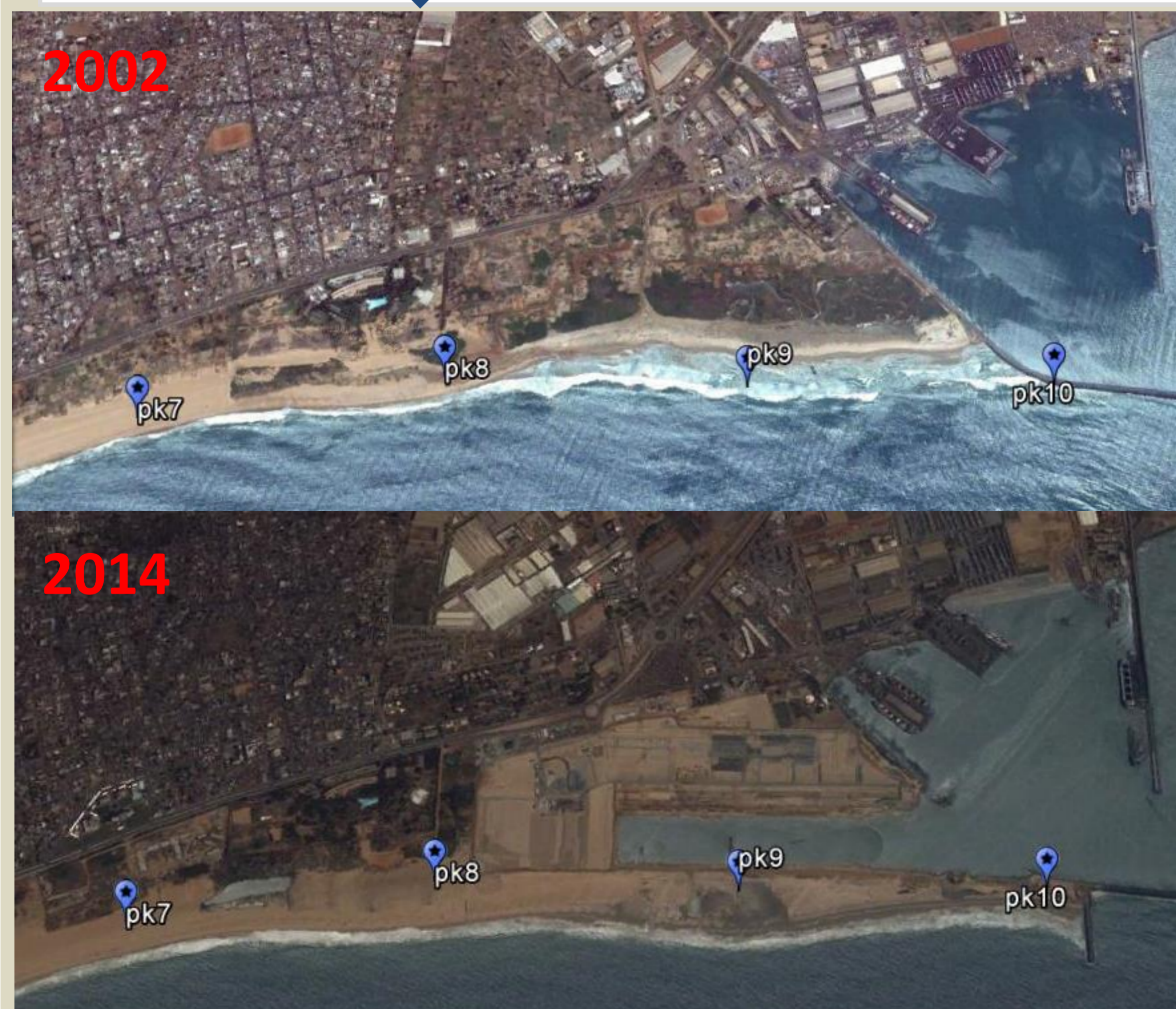
Accrétion (+260 m entre 2002 et 2015) de la plage en amont du port de Lomé.
