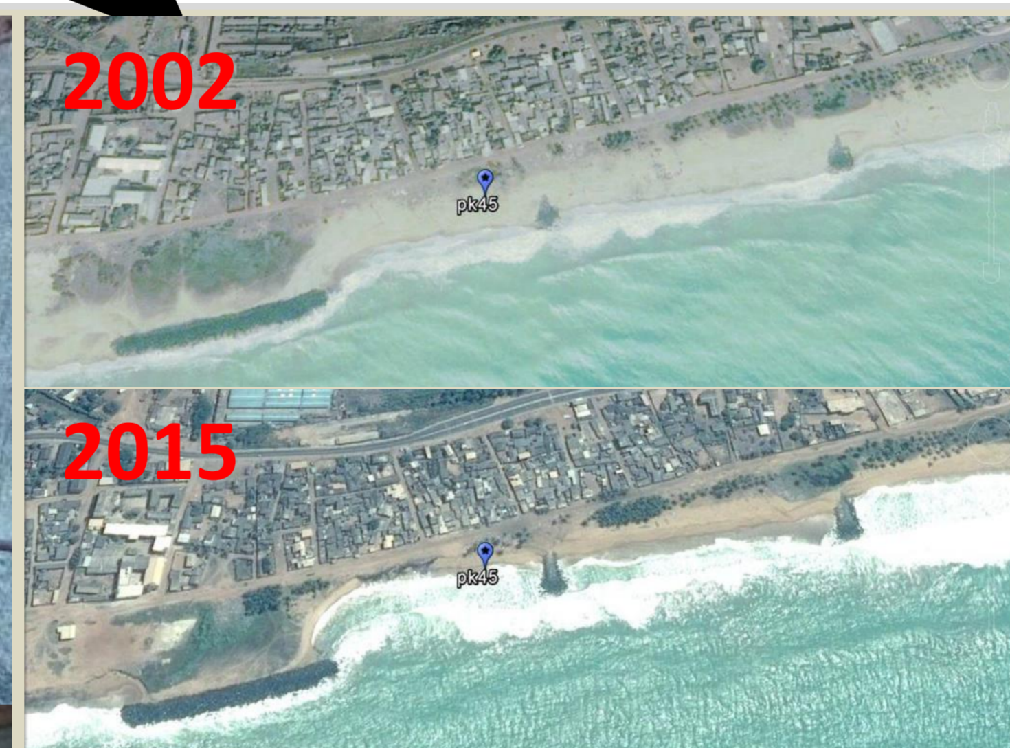
Relative stabilité (évolution <1 m/an) du trait de côte suite à la construction d'ouvrages de protection du littoral (km 45).
