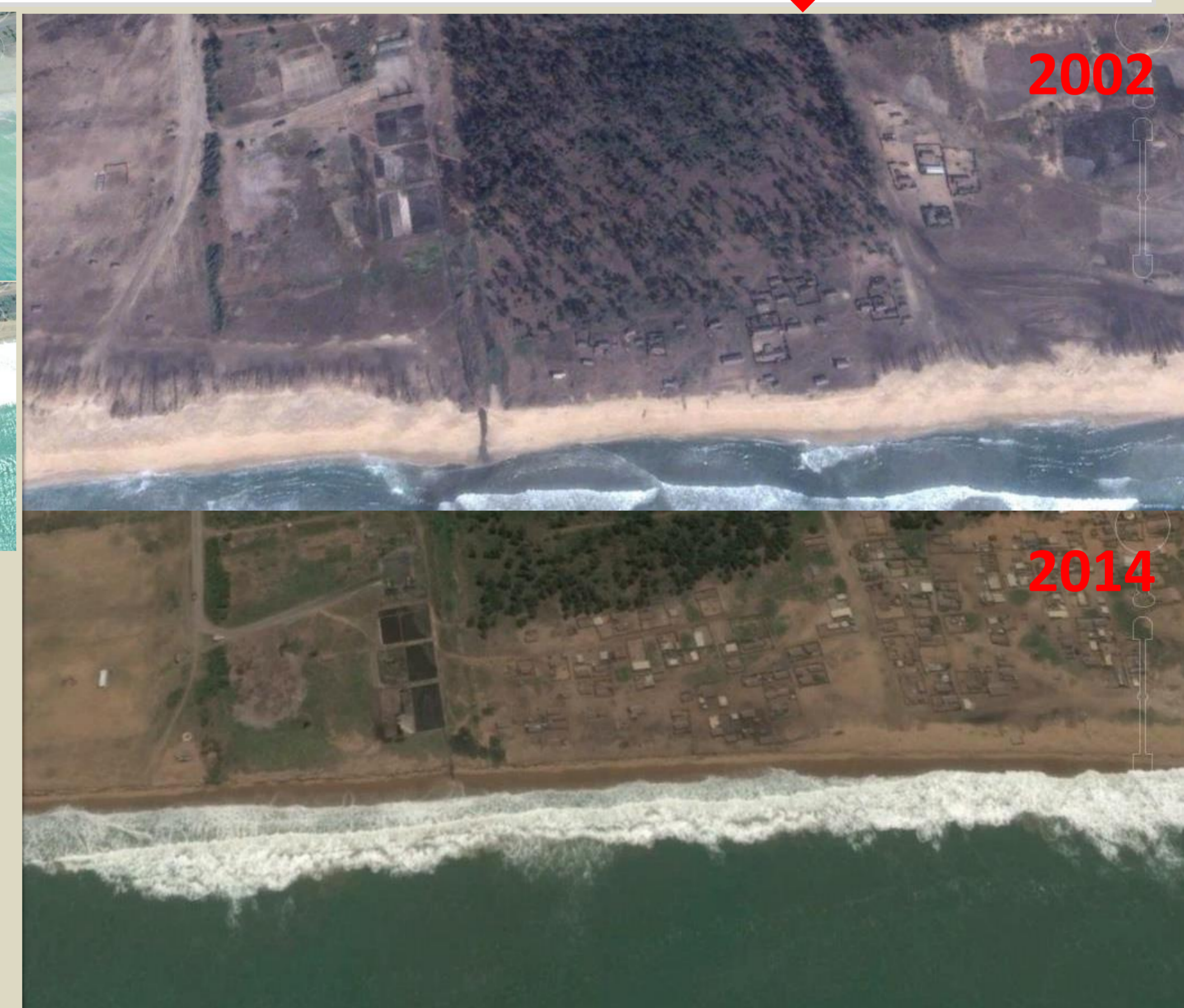
Erosion (-120 m entre 2002 et 2014) de la plage 12 km en aval du port de Cotonou.
