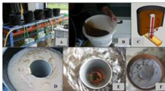
Figure 12. Description du lavage des échantillons. Vue globale de l'installation d'extraction des résidus (A), Transfert d'un échantillon après 48 heures de trempage (B), Schéma du système d'extraction (C), Vue de l'entraînement des résidus de culture par le courant d'eau et chute de ces derniers dans le tube central (D), Récupération des résidus sur le filtre (E), Aperçu de ce qui est récupéré sur le filtre (F) (Vancutsem et al., 2012).
