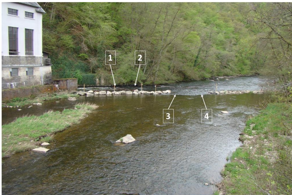
Figure 6 : Vue amont du dispositif de détection installé à Heid de Goreux avec les antennes 1 et 2 à gauche de l'image (canal de fuite) et les antennes 3 et 4 à droite (débit réservé au niveau de l'échancrure)
