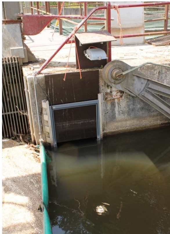
Figure 1 : Antenne de détection RFID à l'entrée de l'exutoire de Lorcé.
