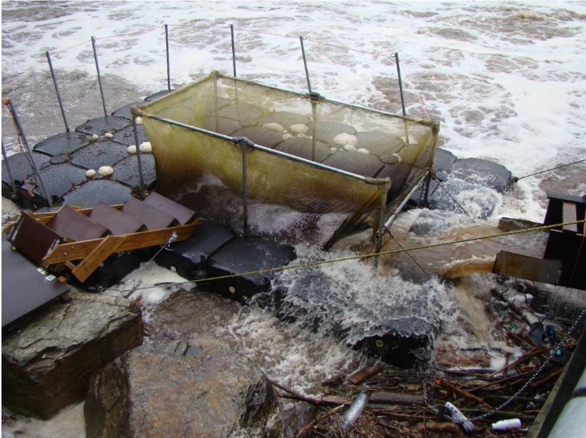
Figure 6 : Piège de dévalaison inefficace lors d'une augmentation de débit de l'Amblève (>30m³/s)
