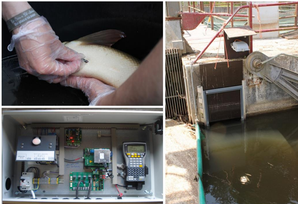
Figure 3 : Marquage d'un barbeau avec un transpondeur RFID de 23mm après une légère incision au niveau de la cavité péritonéale, station automatique de détection RFID (CIPAM) et antenne de détection RFID à l'entrée de l'exutoire de Lorcé.
