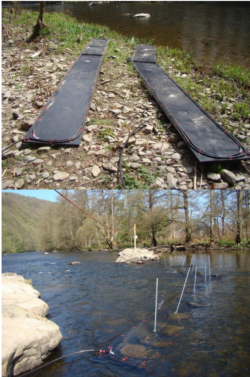
Figure 3 : Antennes RFID installées dans le débit réservé hors de l'eau (en haut) et lestées dans l'eau (en bas)
