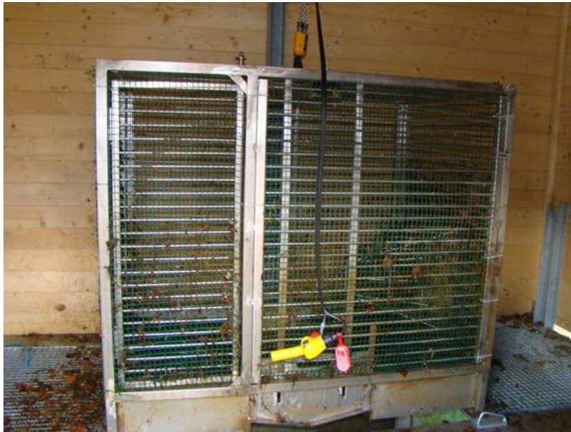
Figure 2 : Cage de capture placée au niveau du bassin le plus en amont de l'échelle à poissons du barrage de Lorcé
