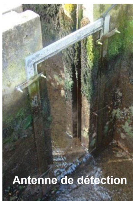
Figure 11 : Equipements d'une station CIPAM de détection automatique des anguilles marquées.
