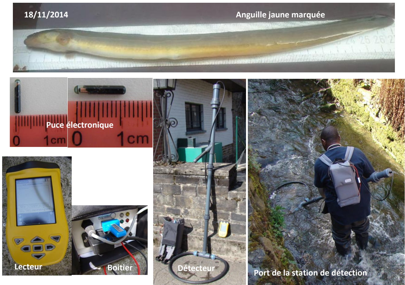
Figure 20. Equipement de marquage (puce électronique) et de suivi durable (lecteur des puces, boitier électronique, détecteur des puces) des jeunes recrues d'anguilles issues du repeuplement en civelles réalisé le 22/05/2013 dans le Mosbeux.
