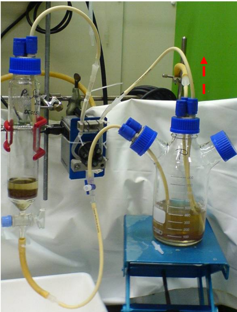
Bild 6.3 Bioleachingreaktor im Labormaßstab. Perkolator mit permeabler Glasfritte und Asche. Bakterienlösung befindet sich im belüfteten Reaktor (Fließrichtung roter Pfeil).
