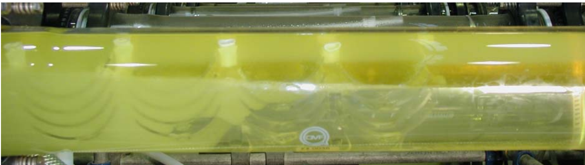
Bild 5.31 Phasentrennung der wässrigen und der organischen Phase im Abscheider
