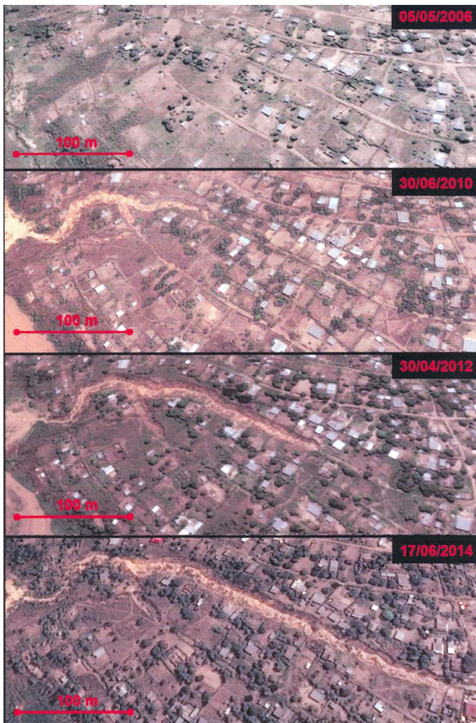
Figure 6 : Evolution d'un ravin en périphérie de Kinshasa tête 2014 : 4°25'41''S, 15°14'15''E) qui s'est développé sur plus de 600 m entre 2006 (inexistant) et 2014 en suivant l'axe de la route.
