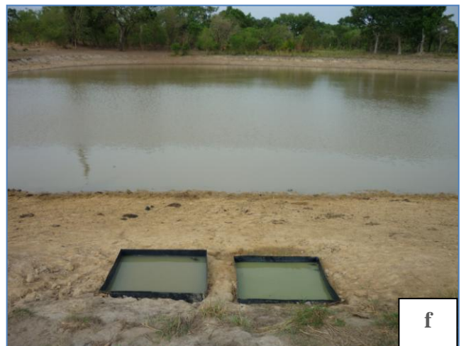
Quelques illustrations du matériel de mesure de l'évaporation et de l'infiltration (a : bac Colorado normal ; b : bac Colorado ouvert à la base ; c : vérification de l'horizontalité du bac enterré ; d et e : vérification de l'égalité des niveaux de l'eau dans les bacs et du sol ; f : vue d'ensemble de l'installation)
