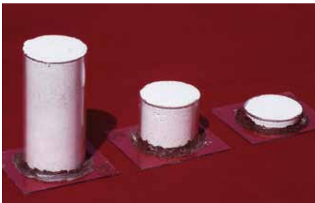
FIG. 16 Glazen tubes gevuld met een mengsel van gebluste kalk en carbonaatvrij zand. Glass tubes filled with a mixture of lime putty and carbonate free sand.
