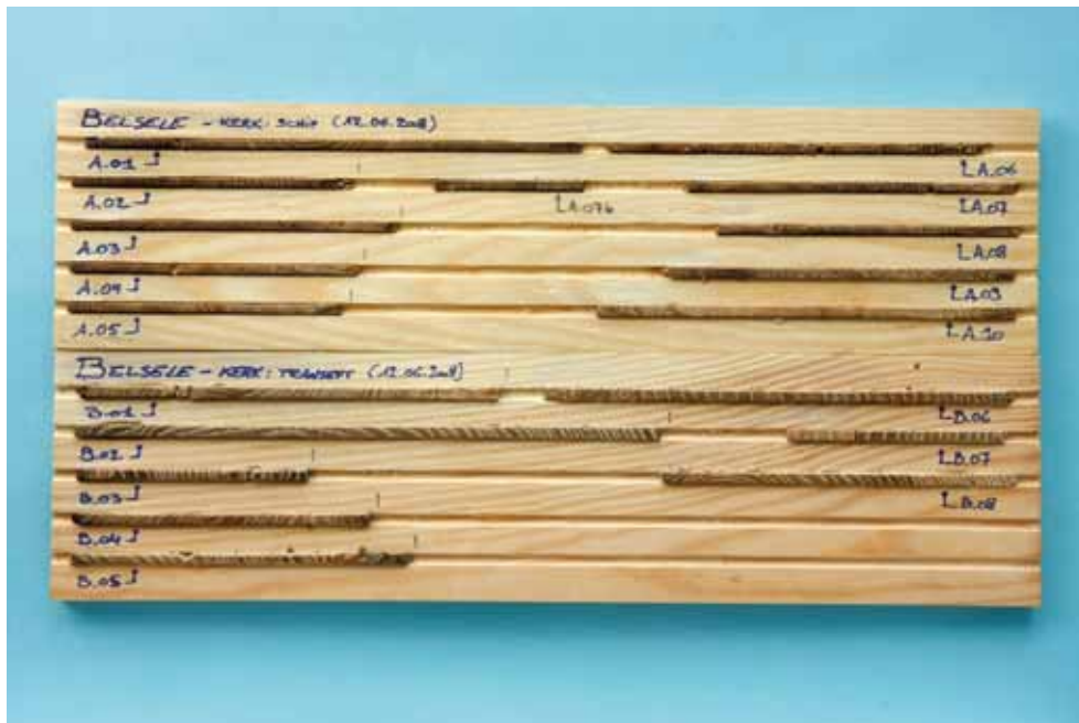
FIG. 7 Boorkernen uit het schip (boven) en transept (onder). Er is tussen beide een duidelijk verschil in de gemiddelde breedte van de groeiringen. Increment cores from the middle aisle (top) and transept (bottom). There is a clear difference in average ring-width between both samples.
