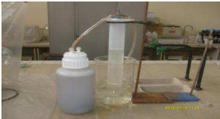
Figure 68 : Schéma du réacteur non aéré
