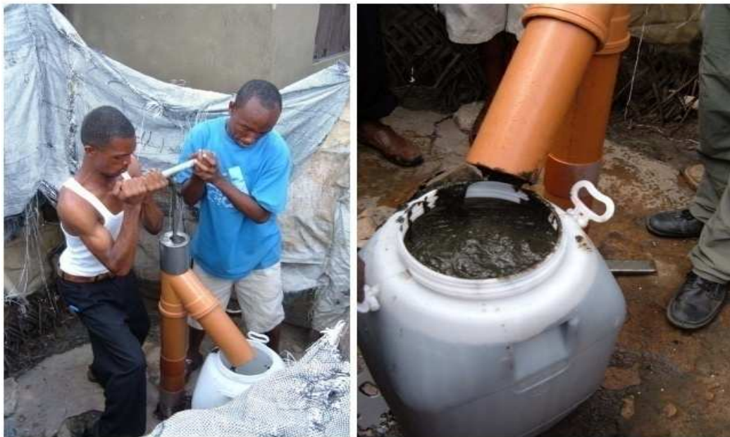
Figure 13 : Exemple de technologie utilisée en vidange semi-mécanique : Gulper (Sugden, 2005)
