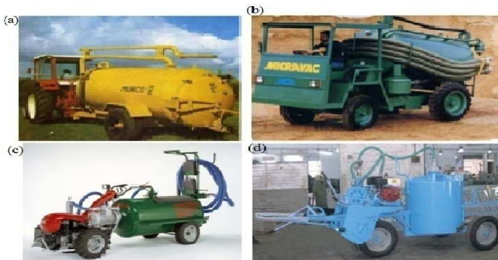
Figure 12 : Véhicules de vidange mécanique (a) Vacuum tank (b) Micravac (c) Dung Beetle et (d) vacutug (O'Riordan, 2009)
