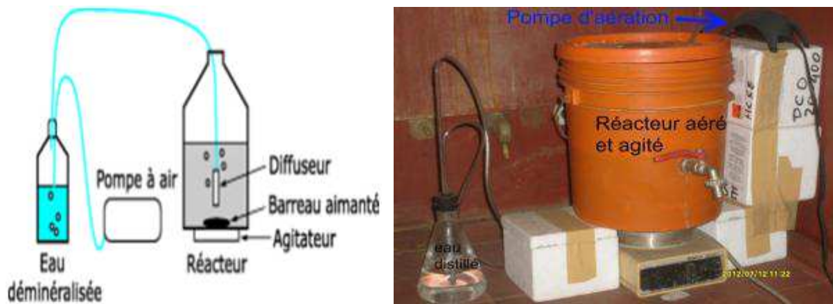
Figure 67 : Dispositif expérimental du réacteur aéré
