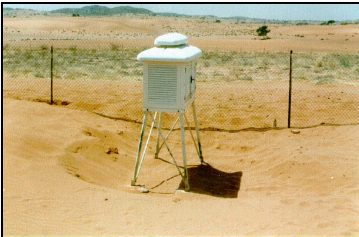
Photo II. 1. : L'ensablement de l'abri à la station synoptique de Gouré témoigne de la remise en mouvement des dunes (pluviométrie annuelle moyenne 1961-1990 : 285 mm). A l'arrière plan, la zone couverte de végétation est une mise en défens. Plus loin encore, le sol sableux est totalement dénudé et remis en mouvement (OZER 1993) [Mars 1993. Cliché : P. OZER].
