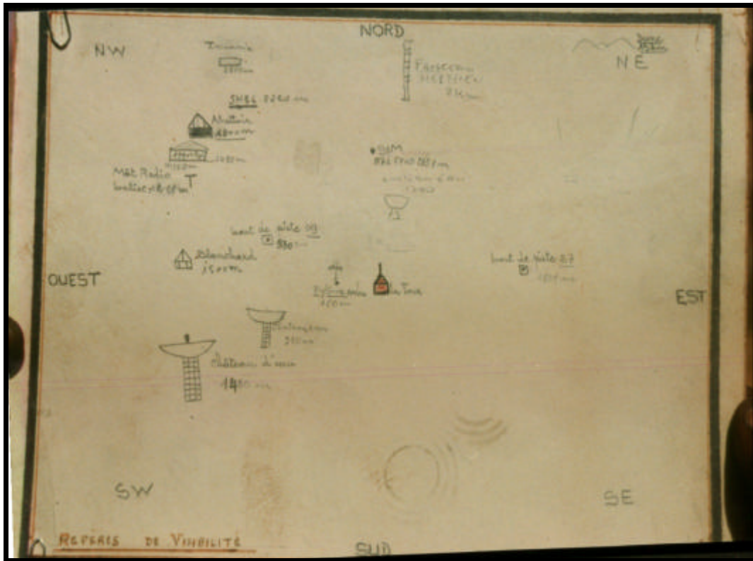
Photo IV. 1 : Schéma de référence utilisé par les observateurs de la station synoptique de Maradi pour estimer la visibilité (OZER 1993).
