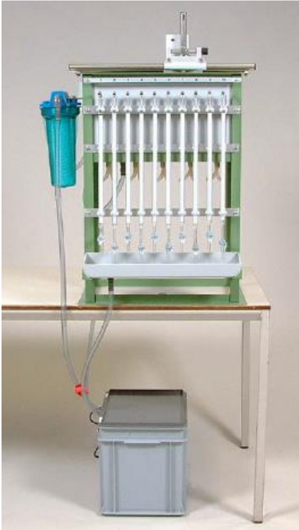
Figure 2-9 : Perméamètre de laboratoire - Laboratory-Permeameter, Eijkelkamp, Giesbeek, Netherlands (Crédit : Eijkelkamp ®)
